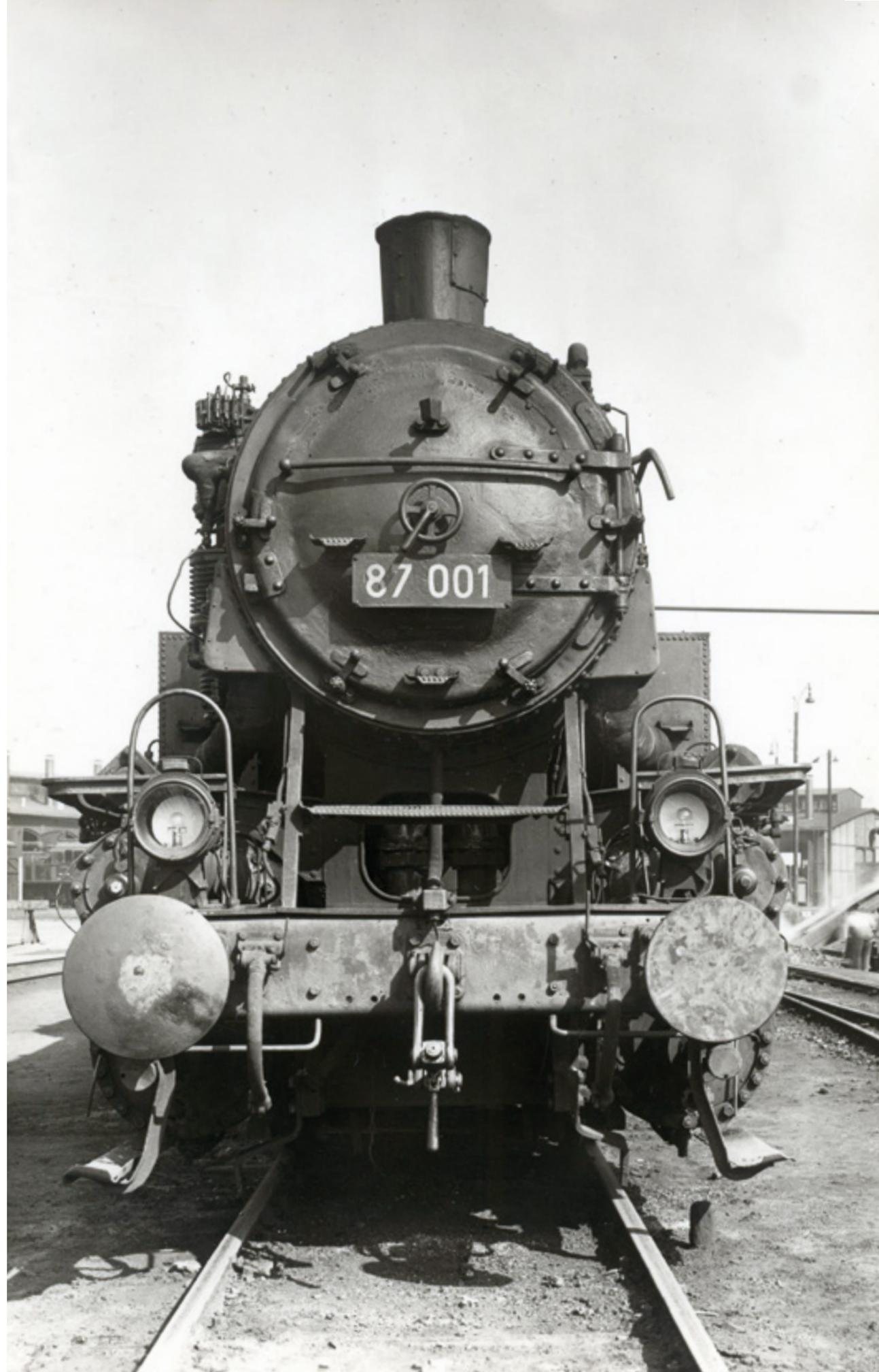
Links: Die Frontansicht soll den Reigen der 87 001 schließen. Sie präsentiert das typische Aussehen der Rangierlokomotiven der Einheitsbauart. Mit einer Dampfheizeinrichtung wurde diese Baureihe nie ausgestattet, da sie nur dem Verschub diente.
